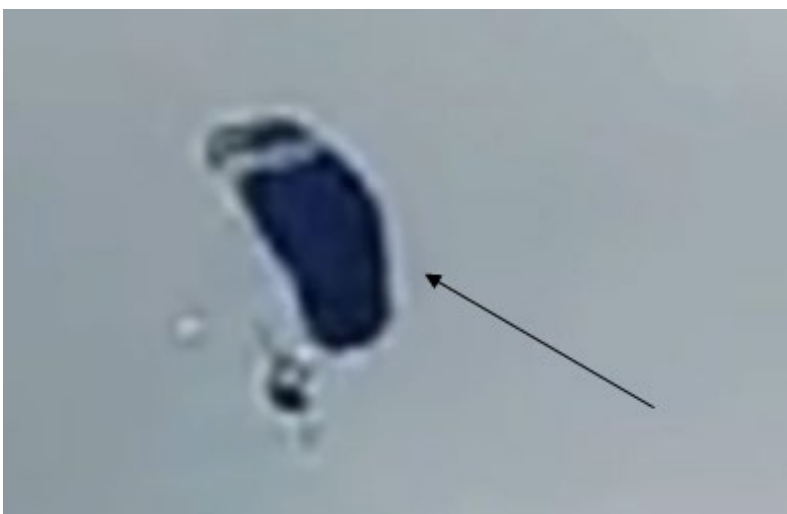
Bild 11. Begynnande stall på vänster sida. Indikeras av att nosen deformeras på vänster sida pga. att fallskärmen slutar flyga på denna sida, se pil.
